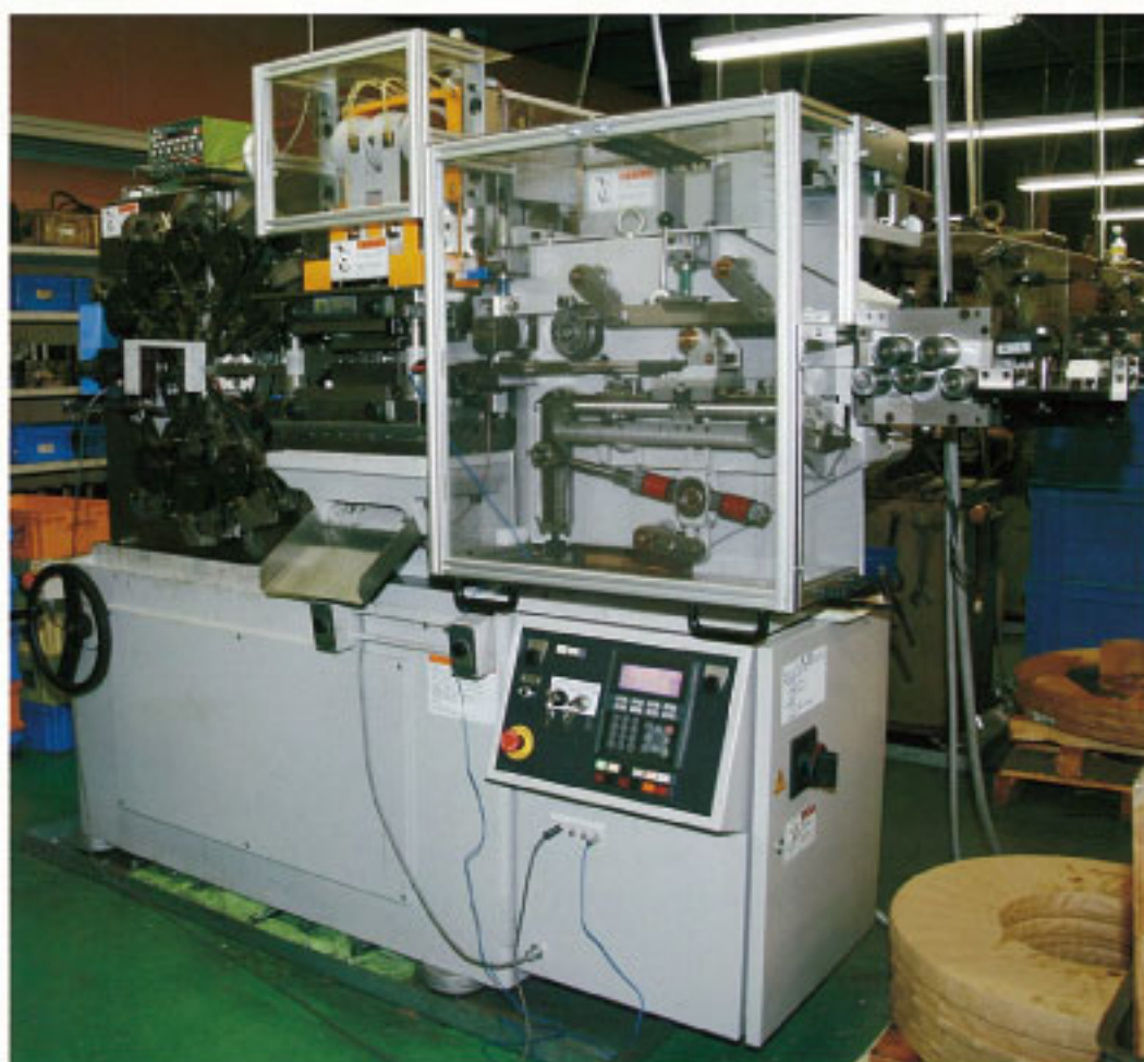
材料のロスを抑えて安定した品質の製品を連続生産できるマルチフォーミング機
